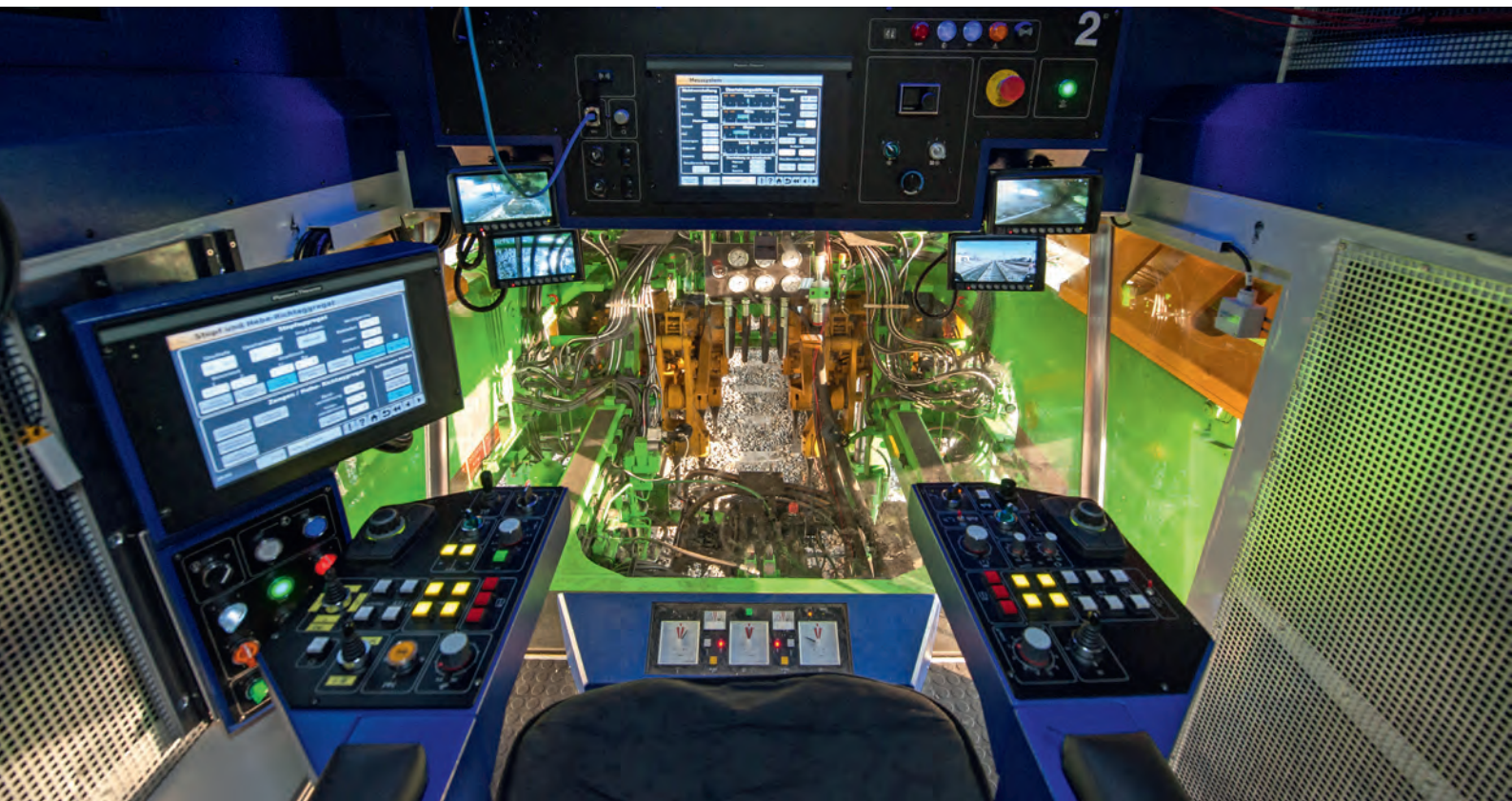
Abb. 1: Noch bessere Erreichbarkeit der Bedienelemente während der Stopfarbeiten
